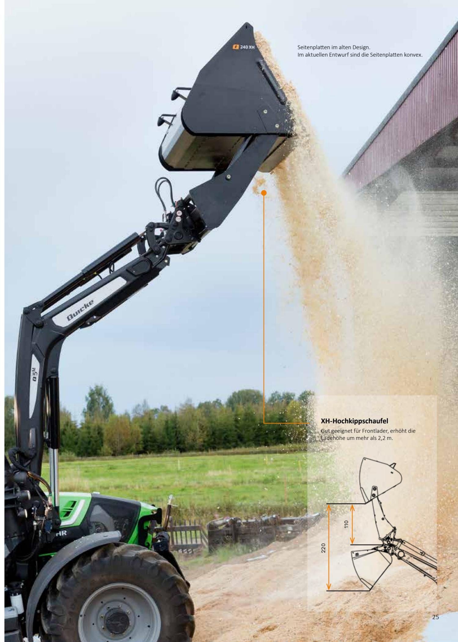
Seitenplatten im alten Design. Im aktuellen Entwurf sind die Seitenplatten konvex.
